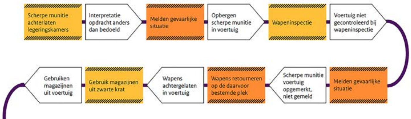
Schematische reconstructie van het schietongeval. In het geel de beheersmaatregelen. In het oranje de niet-uitgevoerde veiligheidsvoorschriften (Bron: IVD).
