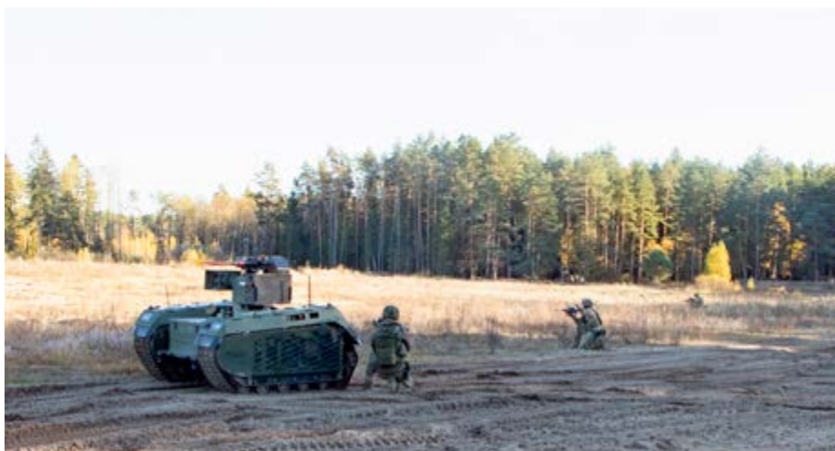
“In Litouwen werd de .50 gebruikt op een Remote Controlled Weapon System ‘R400’ van het bedrijf EOS.”
